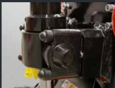
Vérins d'inclinaison avec tiges de piston trempées et paliers sans lubrification.
