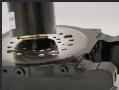
Attache rapide avec joint tournant à montage direct. Permet une haute capacité de débit. La technique minimise l'acheminement de flexibles et le risque de fuites.
