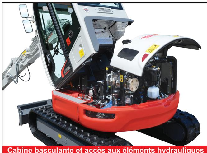
Cabine basculante et accès aux éléments hydrauliques
