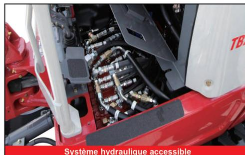
Système hydraulique accessible
