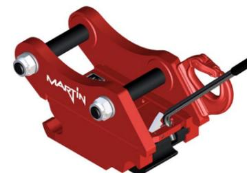
**Système d'attache rapide mécanique (pour les pelles jusqu'à 10 tonnes); adapté à tous les godets MARTIN.**
