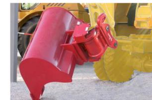
Le système est compatible par exemple avec les godets rétro, les godets butte, les godets crible, les godets curage de fossé inclinables, les marteaux, les bennes ou grappins et tout autre équipements spécial.
